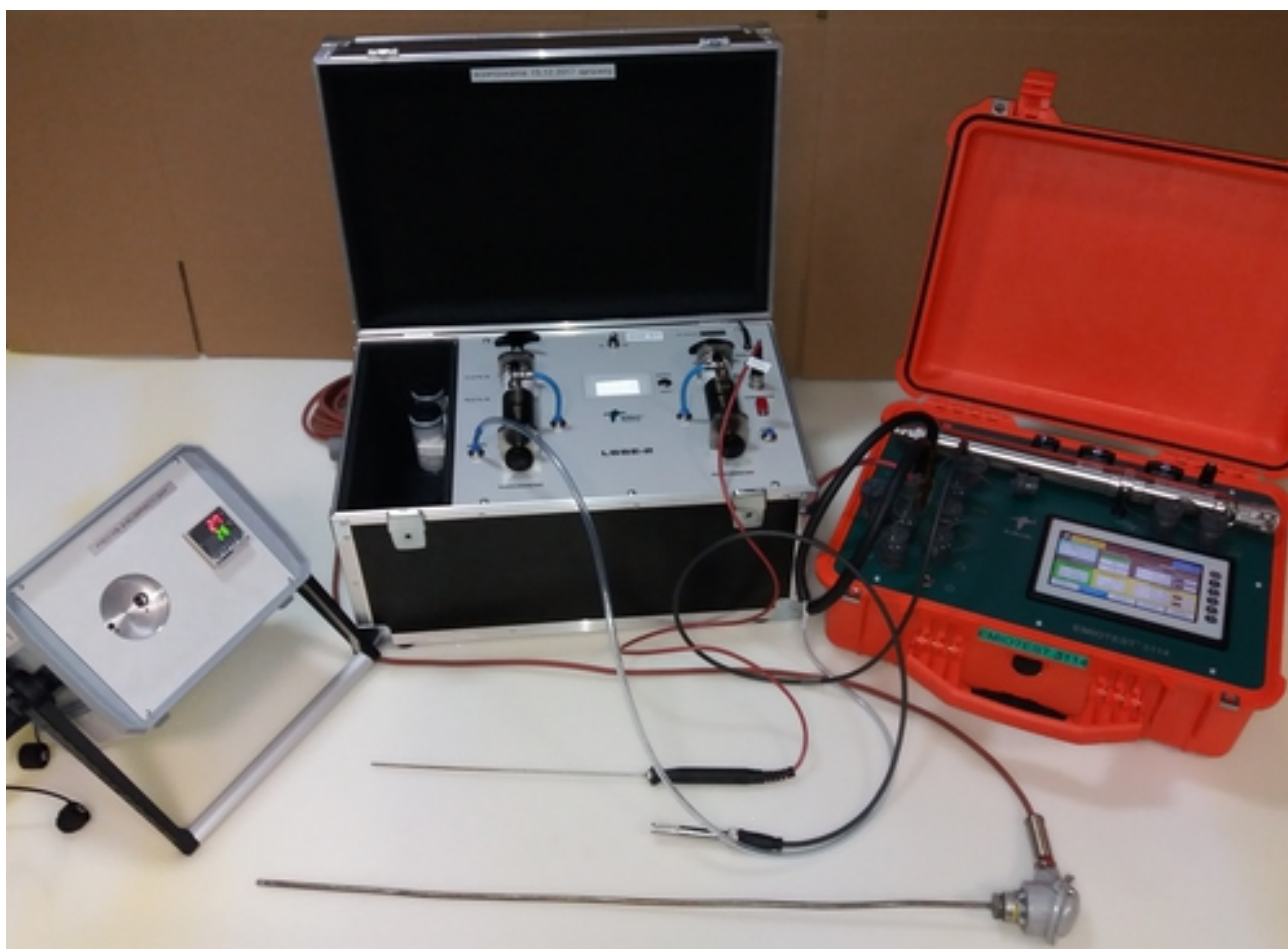
Widok zestawu podczas sprawdzania torów pomiarowych w pyłomierzu Emiotest 3114
