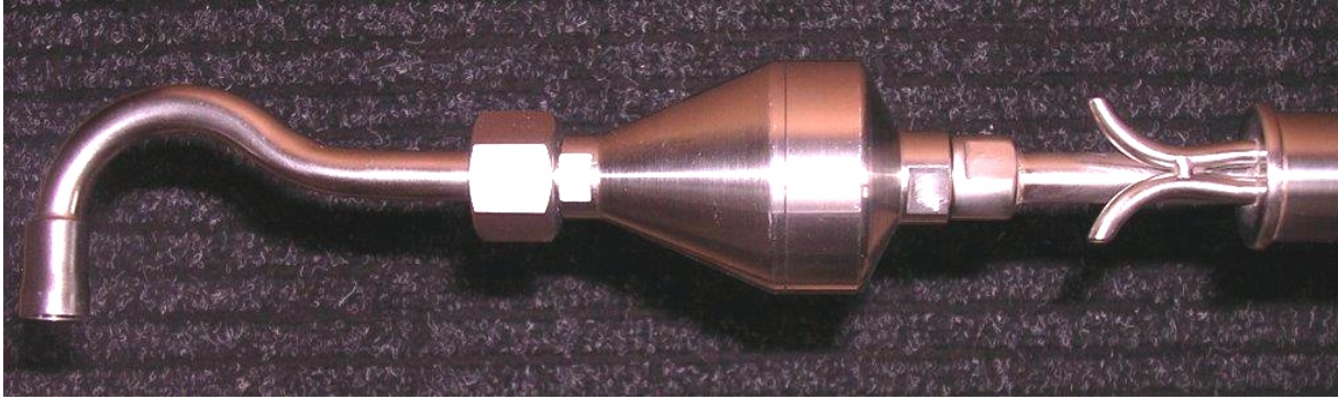
Sonda typu SP-sz z separatorem pyłu FT-50
