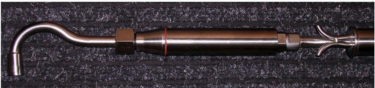
Sonda typu SP-sz z separatorem pyłu FG-30
