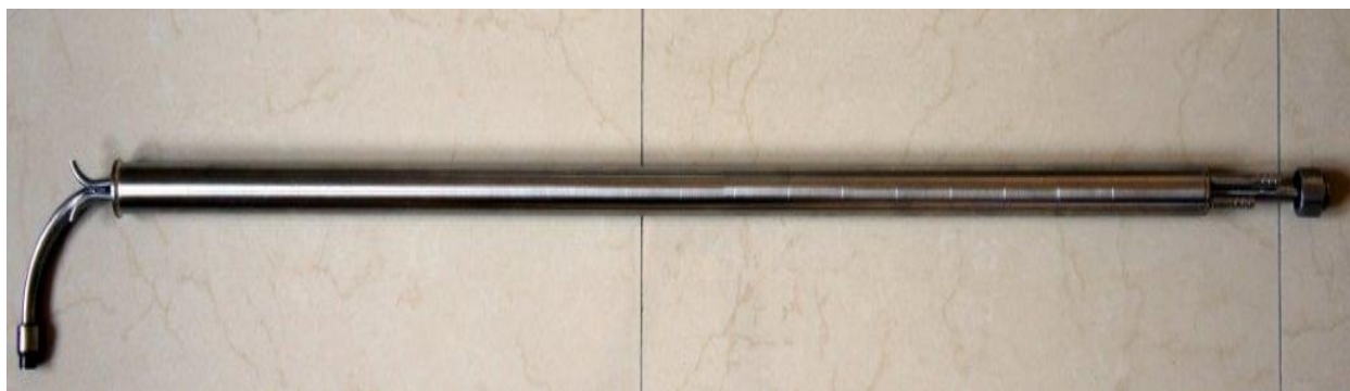
Sonda jednoczęściowa typu SP-ss, nieogrzewana
